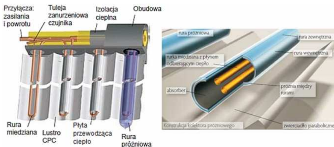
Rys. 9.5. Schemat budowy kolektora próżniowego w wariantcie A
