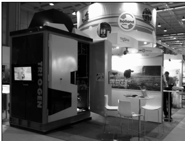
Rys. 10. Układ małej siłowni pracującej na toluenie oferowany przez firmę Tri-O-Gen
