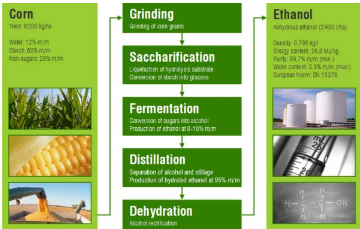
Rys. 9.3. Schemat procesu produkcji bioetanolu z kukurydzy [17].
