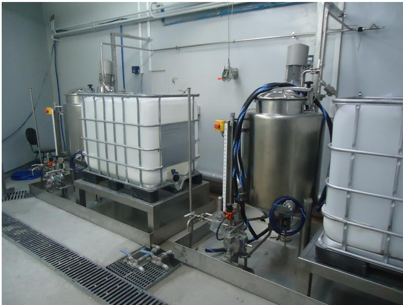
Linia do impregnacji odpadowych surowców włóknistych
