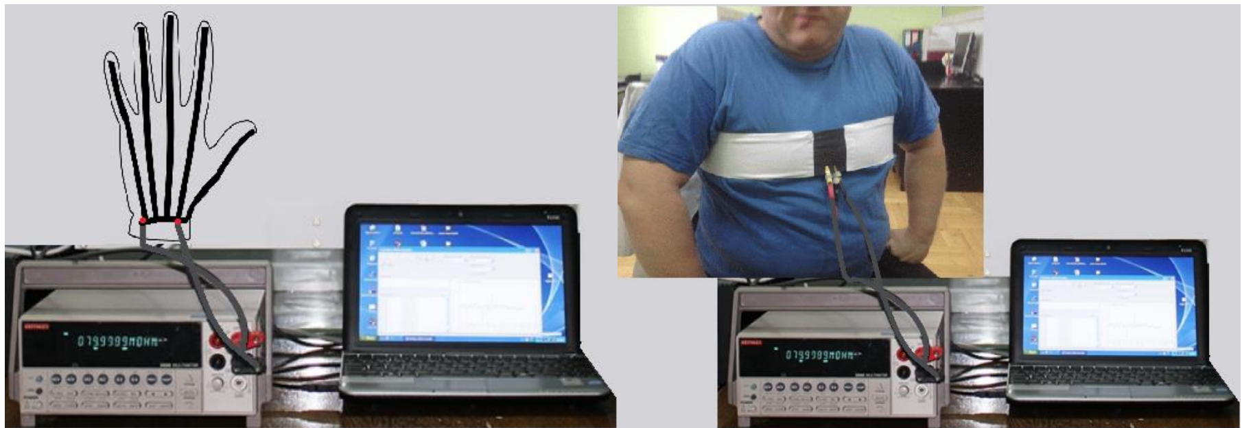
Prototyp rękawiczki reagującej na ruchy palca (a), Opaska reagująca na ruch klatki piersiowej, umożliwiające monitorowanie oddechu (b).
