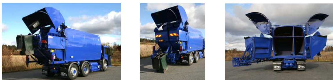
Fotografia 23. Śmieciarka NTM Quatro 8,5 t z oddzielnymi 4 komorami do selektywnej zbiórki odpadów. (9,4 + 4,8 + 4,4 + 2,1 m 3 ) Źródło: http://www.ntm.fi/
