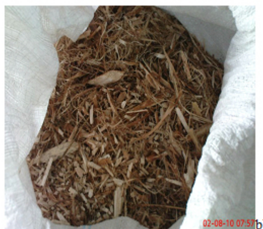
Rys. 2: Sida hermaphrodita a) przed obróbką mechaniczną; b) po obróbce mechanicznej. Źródło dla: a) http://www.zelazkow.fr.pl/forum/thread.php?postid=122 [26.03.2011]; b) źródło własne.
