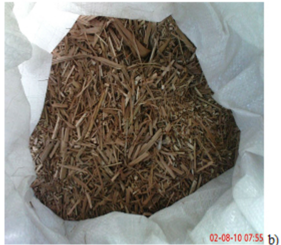
Rys. 1: Miscanthus giganteus a) przed obróbką mechaniczną; b) po obróbce mechanicznej.
