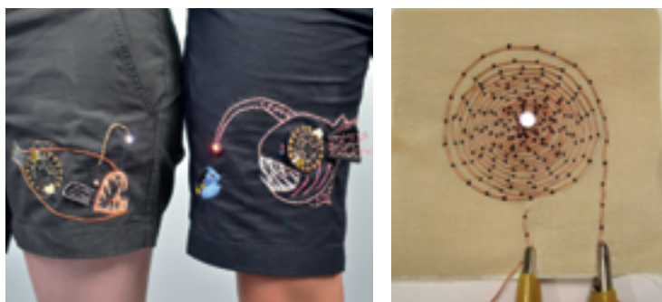
Rysunek 15. Haftowane dekoracyjne układy elektroniczne oraz głośnik, opracowane przez Adafruit.
