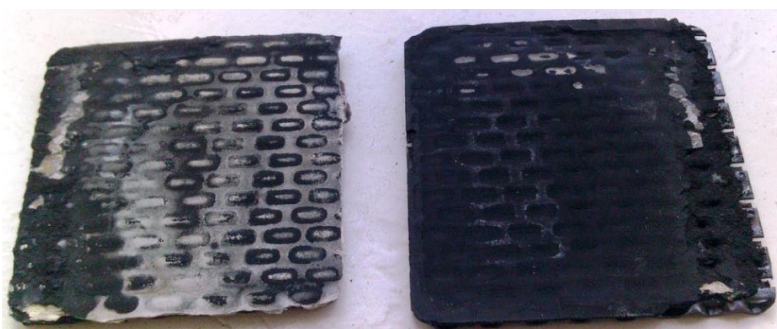
Rysunek 8: Widok na ogniwo paliwowe po pracy na symulowanym biogazie
