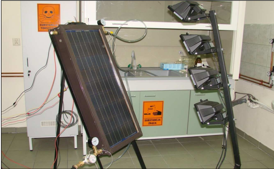
Rys. 9.19. Prototyp numer 2 hybrydowego systemu solarnego – wersja kompletna
