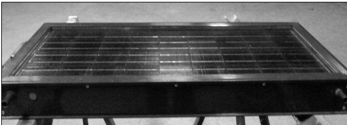
Rys. 9.18. Prototyp numer 2 hybrydowego systemu solarnego – stan surowy
